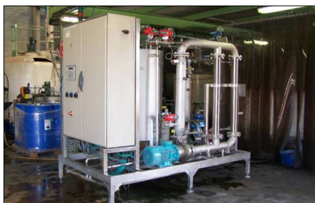
Smurfit Kappa Gallargues ( 30 ) Essais pilotes d'ultrafiltration
